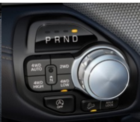
PREVODOVÁ SKRÍŇ S ELEKTRONICKÝM RADENÍM RÝCHLOSTÍ NA POŽIADANIE
